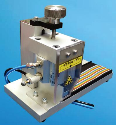
Azionamento a pedale (in dotazione). Inserzione di connettori da 10 poli passo 2, a 50 poli passo 2,54.
