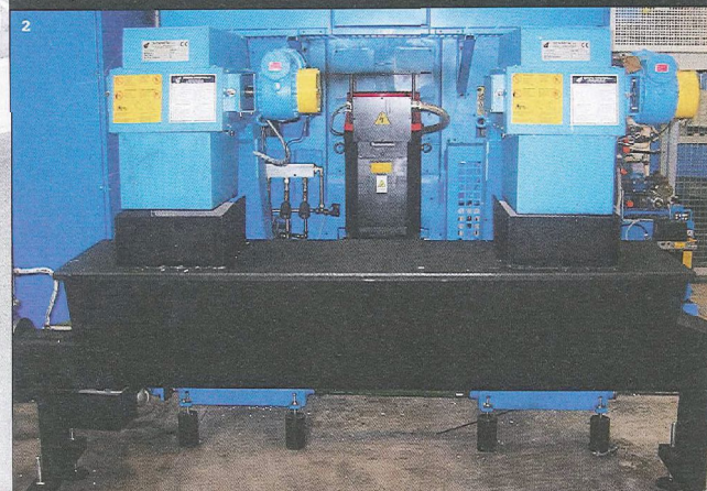
1 Bei Beretta transportiert Govonis Förderer mit der Schraube die Späne über den Maschinen ab.
