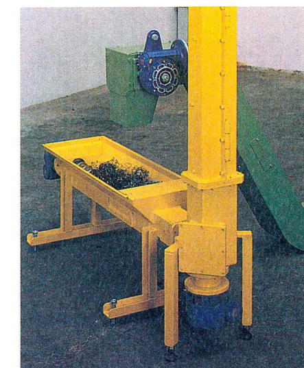
Particolare evacuatore a vite Screw conveyor detail
