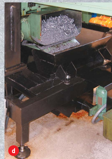
b. Collettori in fossa per trasporto differenziato Underfloor screw conveyors for separate conveyance
