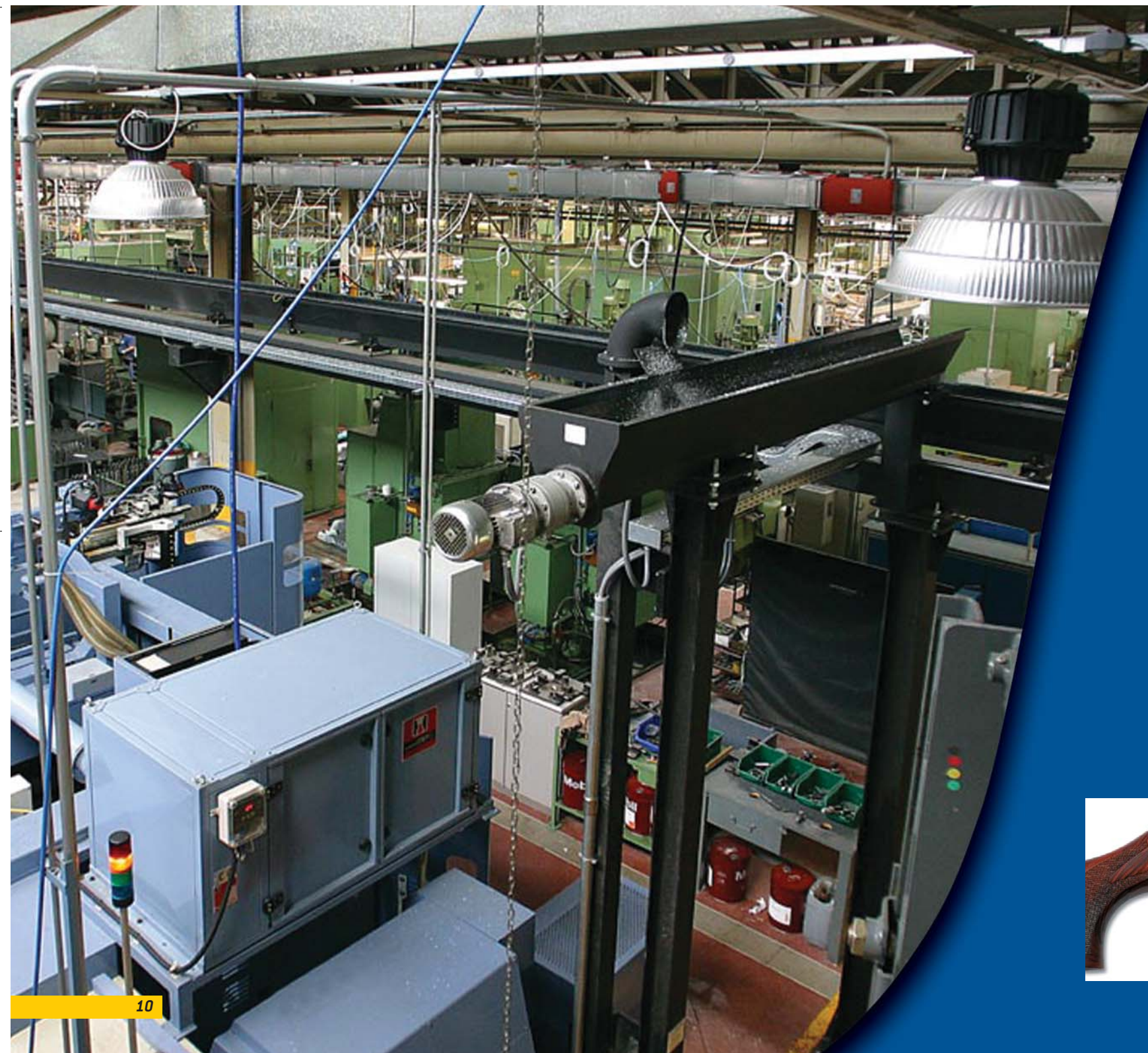
Impianto aereo di trasporto installato presso la ditta Beretta Armi.
