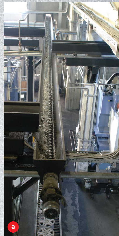
a. Rete di collettori aerei Overhead screw net conveyor
