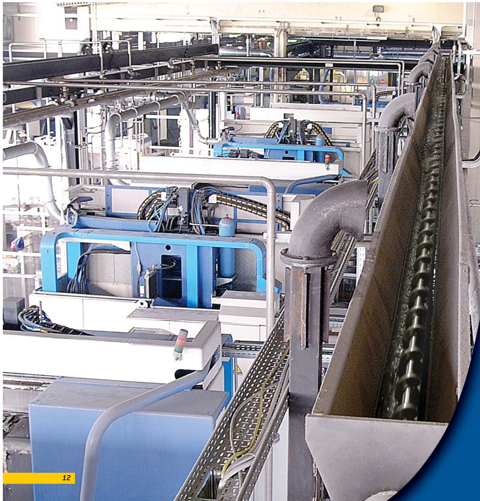
Impianto aereo di trasporto e filtrazione installati presso la ditta BBS.
