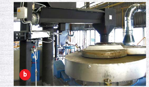
Alimentazione forno elettrico Screw feed electric furnace
