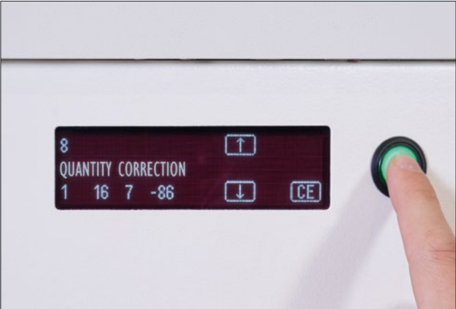
Il picking display Hänel indica il punto in cui è posizionato l'articolo richiesto. Fornisce inoltre informazioni aggiuntive sull'articolo e sulla sua posizione di stoccaggio
