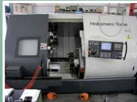
N. 2 TORNIO CN NAKAMURA WT300 BIMANDRINO 2 TORRETTE UTENSILI MOTORIZZATI asse Y mm.120: massimo tornibile D. 270x780
