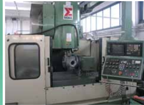
N. 1 CENTRO DI LAVORO VERTICALE SIGMA EK 150 ISO 50 Magazzino 36 utensili: corsa asse X 1500; asse Y 800; asse Z 750
