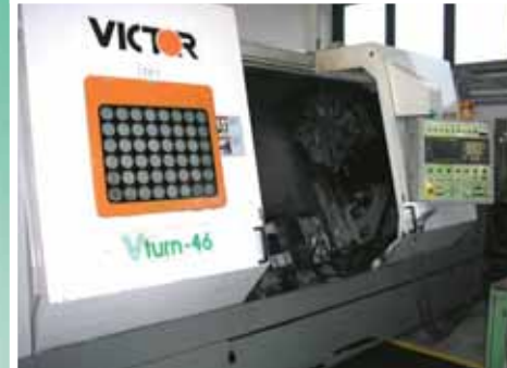
N. 1 TORNIO CN VICTOR V/TURN 46/160 massimo tornibile D.700x1560
