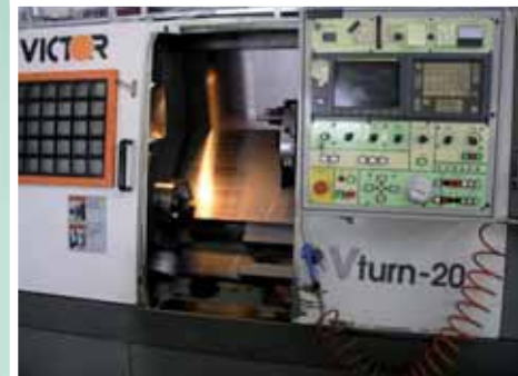
N. 1 TORNIO CN VICTOR V/TURN 20/060 massimo tornibile D.200x500
