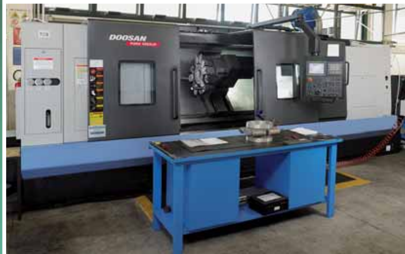
TORNIO CNC 3 ASSI DOOSAN MOD. PUMA 480 XLM con CNC Doosan-Fanuc i-series completo di lunetta autocentrante MORARI mod. SLZC 100-410 con cilindro in linea C100 su supporto a riposizionamento automatico con spalla smontabile Morari. Tornibile L=2940 D. 660
